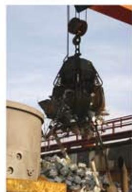
Il materiale di partenza per la produzione dei nostri acciai è rottame accuratamente selezionato.
